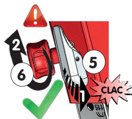
Figure 7 - Verrouiller les 2 coulisses (3) à la même hauteur.
