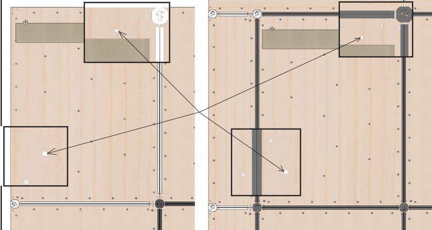
**2** Prépercer le sol (Ø12mm) à travers les trous des plaques
