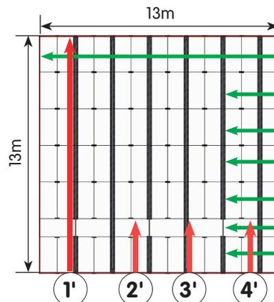
**5/ ! ATTENTION : POUR ÉVITER LA FORMATION DE PLUS, LAISSER REPOSER MINIMUM 24H À TEMPÉRATURE D'UTILISATION (SI TOUTEFOIS DES PLUS APPARAISSENT, SE REPORTER AU § V). ASSEMBLER LES 4 LÉS ENTRE EUX (MÉTHODE IDENTIQUE POUR LES 2 MOQUETTES) :**
