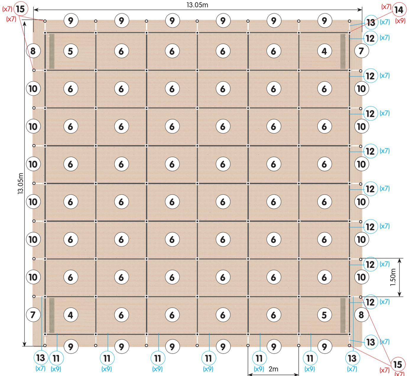
**Figure 9 & détails - Mise en place des pièces de liaison sur la partie centrale du plancher**
