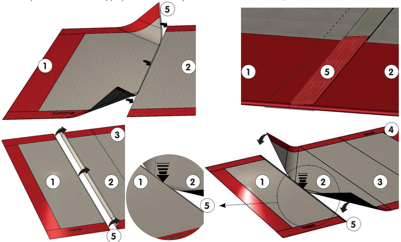
**6/ INSTALLATION DU KIT ANTI-ROTATION MOQUETTE (8) SOUS LES EXTRÉMITÉS DES LÉS CENTRAUX (2) ET (3) (VOIR FIG. 14 CI-CONTRE).**
