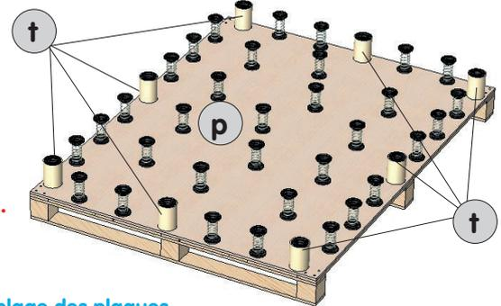
Figure 3 - Disposition et ordre d'assemblage des plaques
