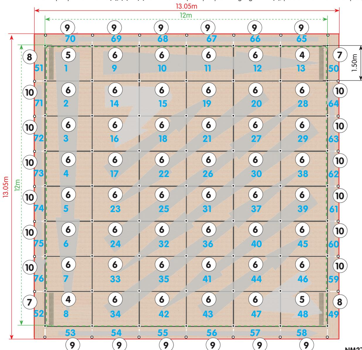
Figures 4, 5, 6, 7 & détails - Orientation des 4 plaques d'angles
