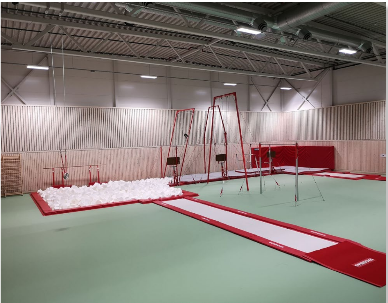
Realización de un foso mixto: foso cubierto integrado y foso hundido con cubos de espuma.
