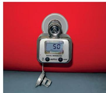
Un manomètre qui permet de régler la dureté de la piste
