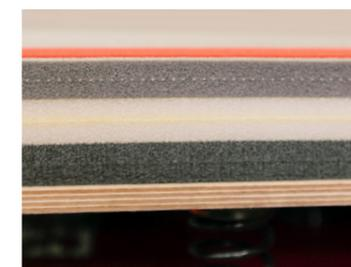
Complexo de espuma com 56 mm de espessura
