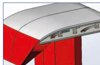
Detalhe das molas que permitem um retorno dinâmico e rápido
