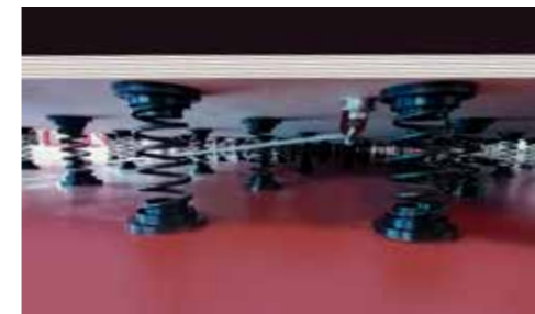
Optimale Dämpfung durch 2709 strategisch positionierte Federn
